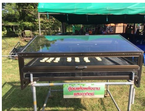
ภาพที่ 2.5 ระบบการอบแห้งแบบ Passive
