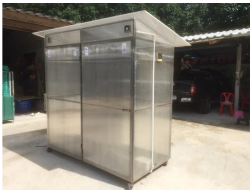
ภาพที่ 2.7 ระบบการอบแห้งแบบ Hybrid
